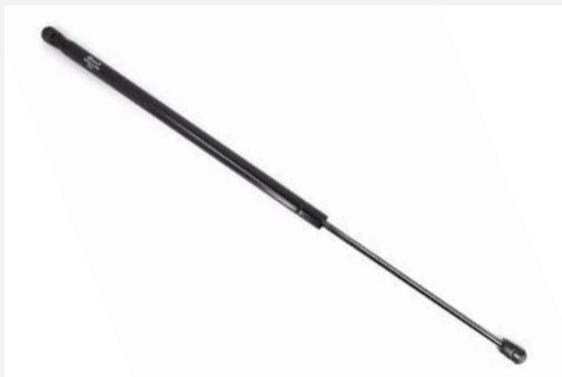
**АМОТИЗАТОР (УПОР) КРЫШКИ БАГАЖНИКА**
