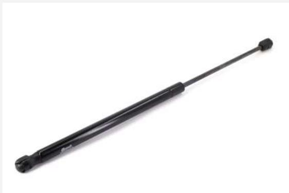
**АМОРТИЗАТОР (УПОР) КАПОТА ГАЗОВЫЙ**
