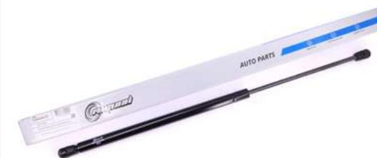
**АМОТИЗАТОР (УПОР) КРЫШКИ БАГАЖНИКА**
