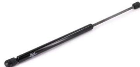
**АМОРТИЗАТОР (УПОР) КРЫШКИ БАГАЖНИКА**
