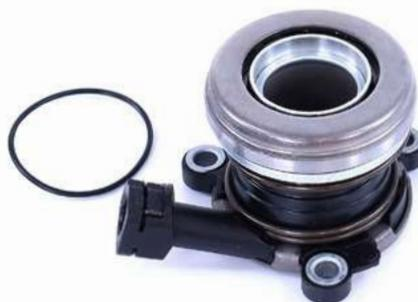
**МУФТА ВЫКЛЮЧЕНИЯ СЦЕПЛЕНИЯ ГИДРАВЛИЧЕСКАЯ**
