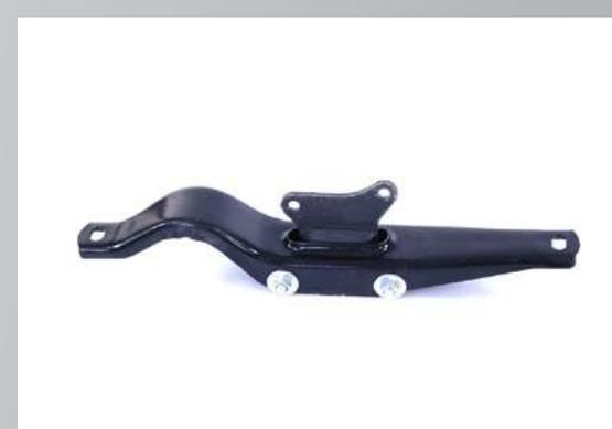
**ПОПЕРЕЧИНА ЗАДНЕЙ ПОДВЕСКИ ДВС (ТРАВЕРСА)**
