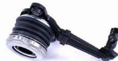
**МУФТА ВЫКЛЮЧЕНИЯ СЦЕПЛЕНИЯ ГИДРАВЛИЧЕСКАЯ**
