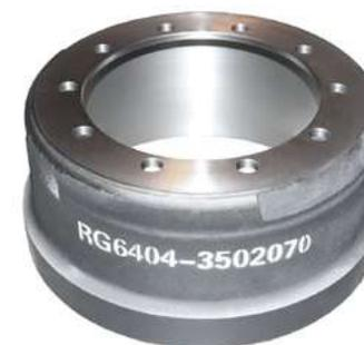
**БАРАБАН ТОРМОЗНОЙ ЗАДНИЙ**
