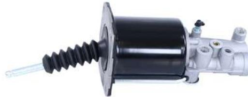
**ПНЕВМОГИДРОУСИЛИТЕЛЬ ВЫКЛЮЧЕНИЯ СЦЕПЛЕНИЯ**
