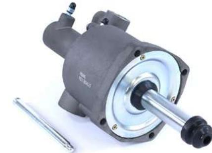
**ПНЕВМОГИДРОУСИЛИТЕЛЬ ВЫКЛЮЧЕНИЯ СЦЕПЛЕНИЯ**
